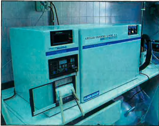
A l'esquerra, congelador programador, controla la temperatura. A la dreta, tanc de nitrogen líquid, s'utilitza per a conservar les medul·les.
