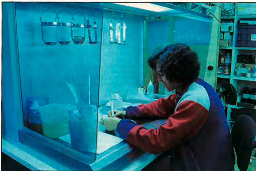
A l'esquerra, càmera de flux laminat, crea un ambient estèril. A la dreta, separador de cèl·lules, purifica les cèl·lules congelades
