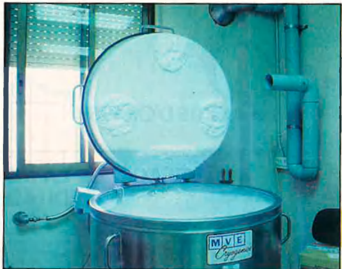
A l'esquerra, congelador programador, controla la temperatura. A la dreta, tanc de nitrogen líquid, s'utilitza per a conservar les medul·les.
