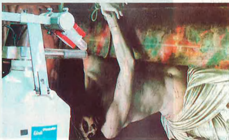
Obres dels anomenats primitius valencians són analitzades per un equip de la Universitat de València. La tècnica utilitzada s'anomena fluorescència de raigs X i es pot utilitzar sense extreure la més mínima part de l'obra. (Fotos: Universitat de València)
