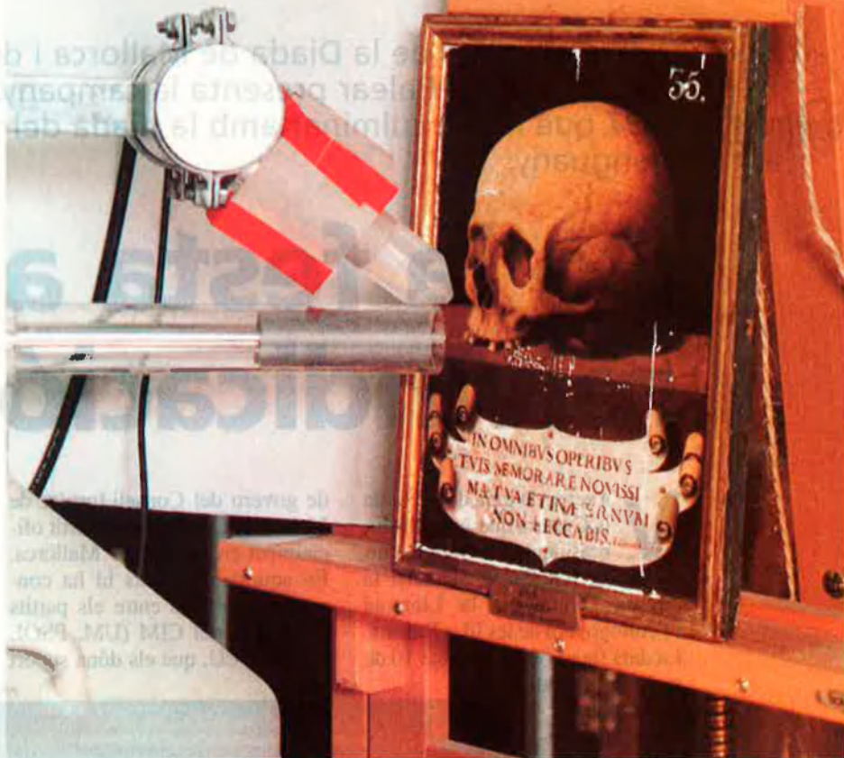
Obres dels anomenats primitius valencians són analitzades per un equip de la Universitat de València. La tècnica utilitzada s'anomena fluorescència de raigs X i es pot utilitzar sense extreure la més mínima part de l'obra. (Fotos: Universitat de València)
